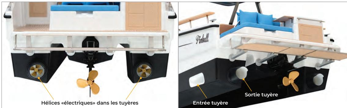
Les tuyères sont des tubes de 30 cm de diamètre, au niveau de l'hélice, profilés pour accélérer le flux d'eau en marche avant.
