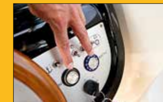
Passer du mode thermique à l'électrique se fait au moyen d'un simple bouton.
