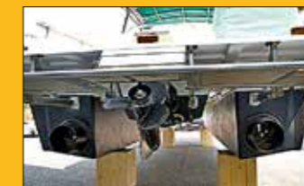
Ce Pinball est bien un hybride : deux moteurs électriques et un thermique.
