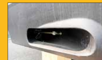
Ce sont dans ces tuyères que prennent place les hélices du moteur électrique.
